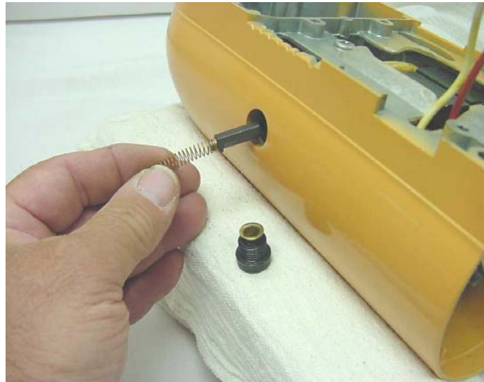
Abb. 29: Schraubkappen lösen, um Kohlebürsten auszubauen. Einbaulage unbedingt markieren.
