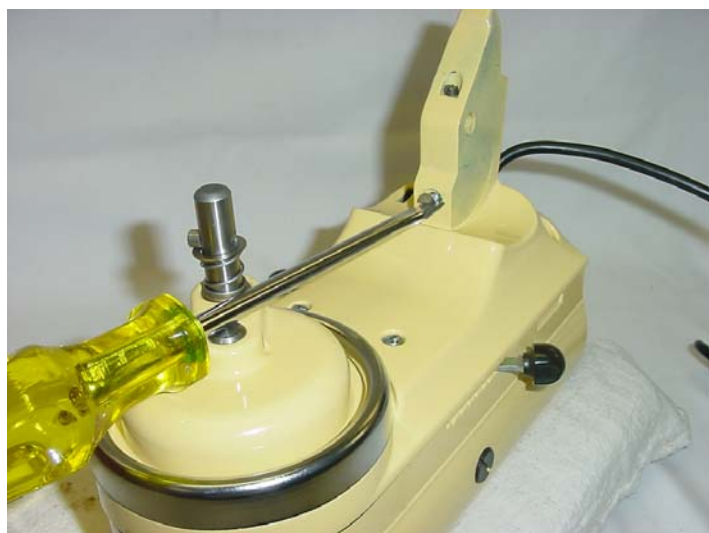
Abb. 69: Einstellschraube mit Nyloneinsatz; sie darf im Gewinde nicht locker sitzen.
