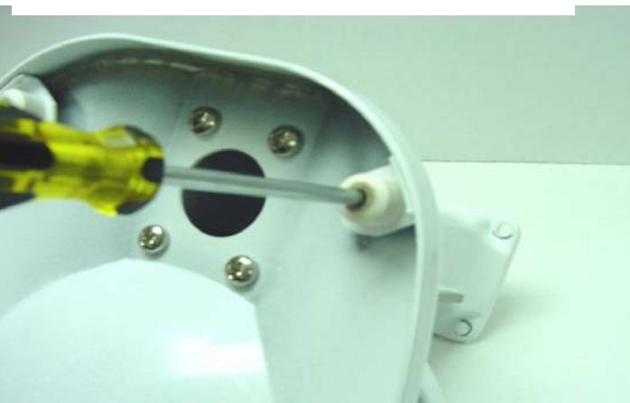
Abb. 93: Bei älteren Modellen vier Rundkopfschrauben entfernen, um die Füße auszubauen.
