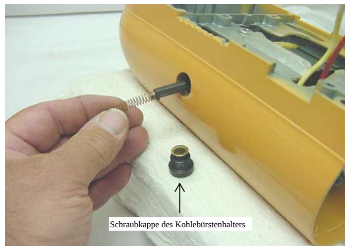
Abb. 42: Einsetzen einer Kohlebürste in den Kohlebürstenhalter.
