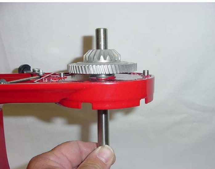
Abb. 54: Ausbau der senkrechten Zentralwelle aus der unteren Getriebeabdeckung.
