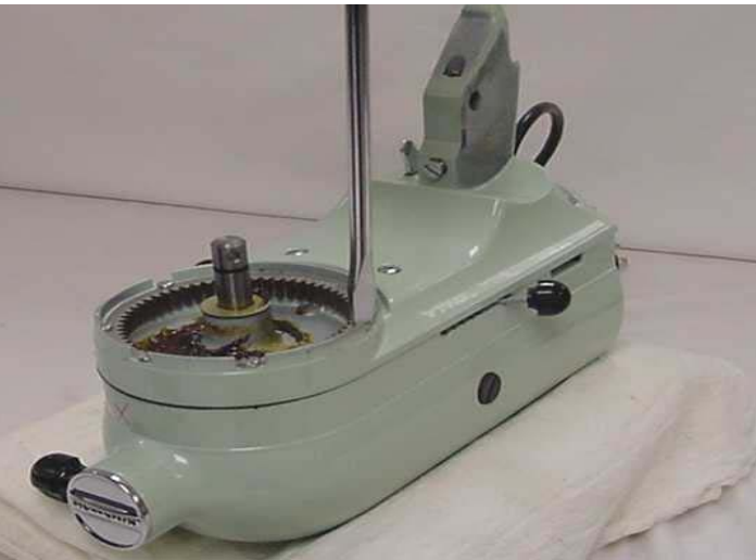
Abb. 10: Ausbau der fünf Spezialschrauben des Innenzahnrads.
