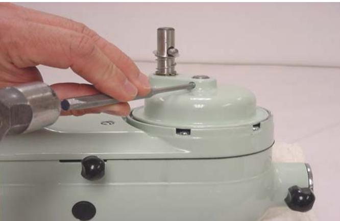
Abb. 6: Kerbstift der Planeteneinheit an der senkrechten Zentralwelle austreiben.
