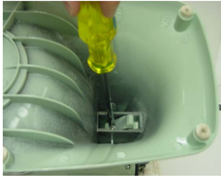
Abb. 3: Madenschraube des Scharnierstifts lösen, bevor der Sockel entfernt wird.
