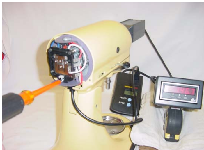
Abb. 79: Untere Einstellschraube der Kontrollplatte für Stufe 6. F. Alle Geschwindigkeitsstufen von STIR (Stufe 1) bis 10 prüfen. Sind STIR und Stufe 6 korrekt eingestellt, sollten die übrigen Stufen automatisch stimmen. Zwischen Stufe 8 und 10 muss eine deutlich wahrnehmbare Drehzahlerhöhung vorhanden sein.
