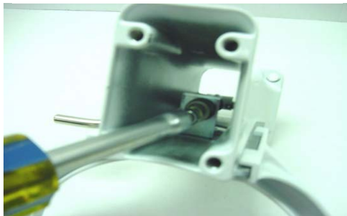
Abb. 92: Kronenmutter am Schlüsselhebermechanismus auf ausreichende Vorspannung prüfen.
