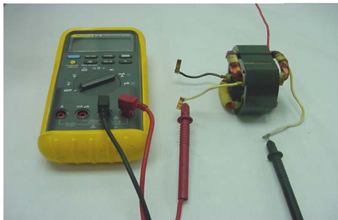
Abb. 35: Die beiden Statorwicklungen mit einem auf niedrigen Messbereich eingestellten Ohmmeter prüfen. Bei der oberen Wicklung eine Messleitung an die rote, die andere an die schwarze Leitung anschließen. Ein niedriger Widerstandswert bedeutet, dass die Wicklung in Ordnung ist. Zweite Wicklung ebenso prüfen. Zeigt das Messgerät 0 beziehungsweise gar keinen Ausschlag im Sinne einer fehlerhaften Wicklung, muss der Stator ersetzt werden.
