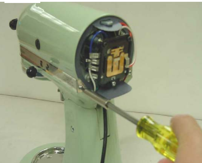
Abb. 2: Zierband nach Entfernen seiner Schrauben abnehmen.
