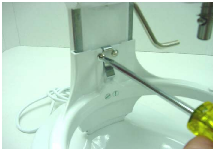
Abb. 95: Zwei Schrauben halten die Federverriegelung der Schüssel.
