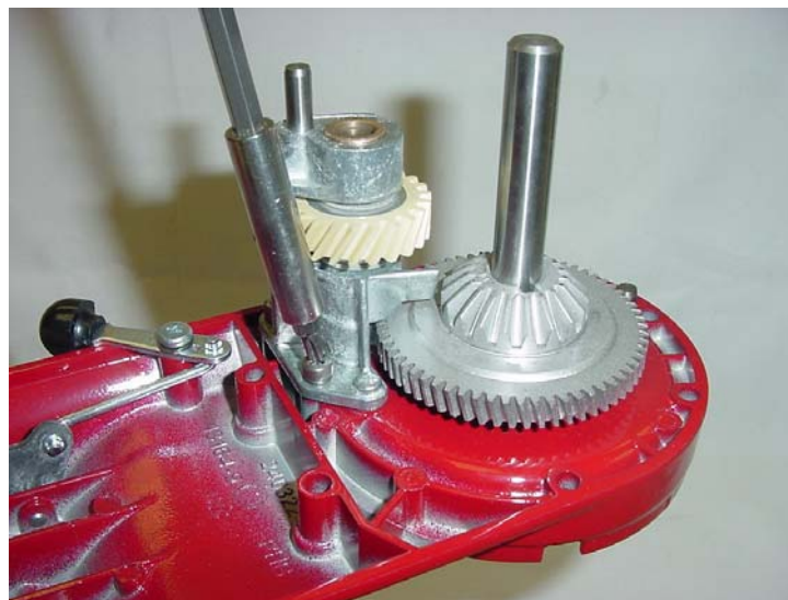
Abb. 52: Lager-/Halterbaugruppe von Schneckenrad und Ritzel.
