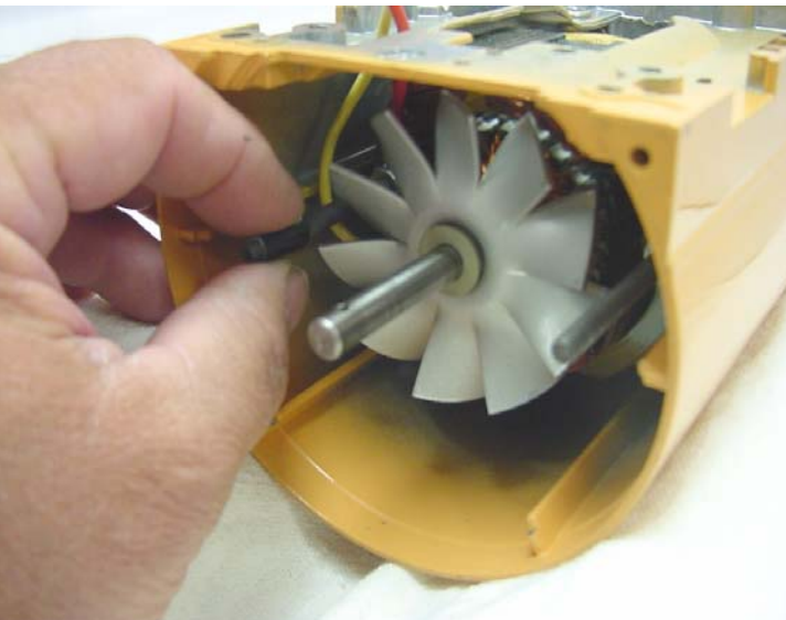
Abb. 28: Hülse des Motorstehbolzens nach Ausbau der Lagerbrücke entfernen.
