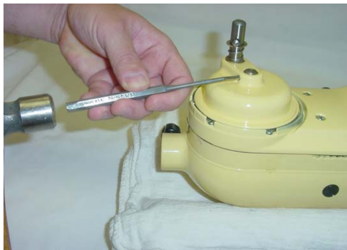
Abb. 68: Kerbstift vorsichtig in die Welle der Planeteneinheit eintreiben.
