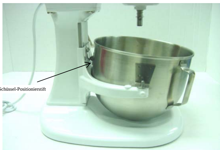
Abb. 96: Einsetzen der Schüssel in den Schüsselträger.
