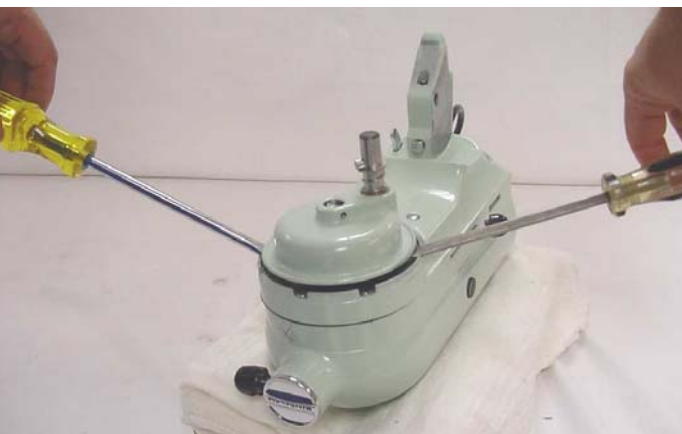
Abb. 7: Planeteneinheit mit zwei Schraubendrehern von der Welle hebeln.
