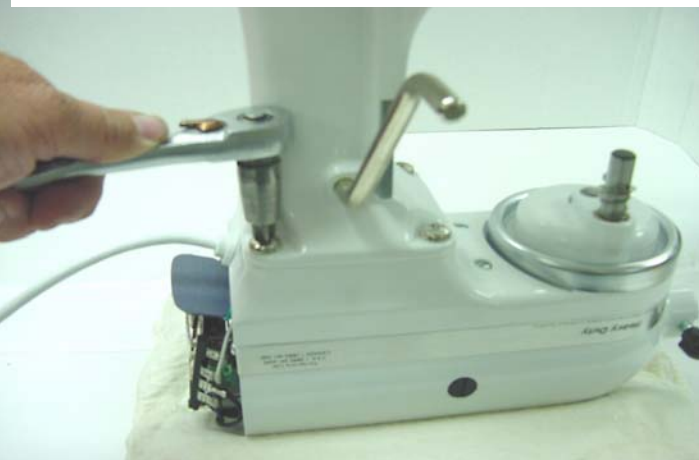
Abb. 84: Vier Kreuzschlitz-Rundkopfschrauben zum Ausbau des Schüsselträgers entfernen.
