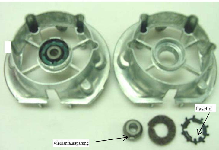
Abb. 40: Lagerbrücke montiert und zerlegt.
