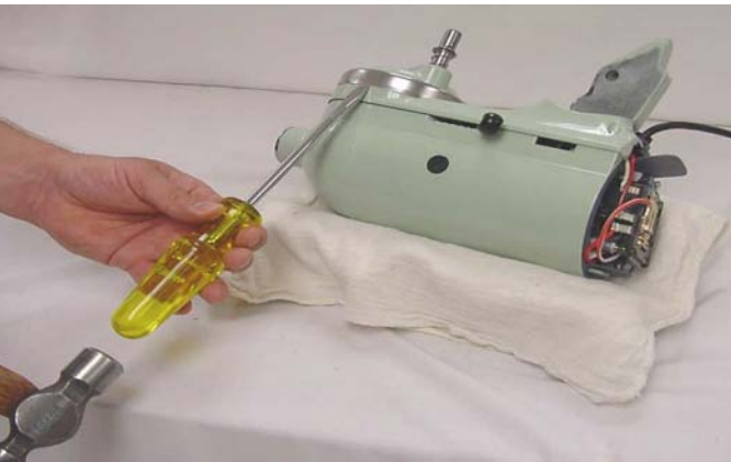
Abb. 5: Der Tropfring sitzt stramm und wird zunächst durch vorsichtiges Klopfen gelöst. Mit einem 5/32"-Durchschlag den Kerbstift austreiben, der die Planeteneinheit auf der senkrechten Zentralwelle hält (Abb. 6).
