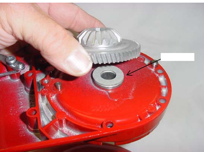
Abb. 55: Zentralzahnrad zur Prüfung aus dem Gehäuse heben.
