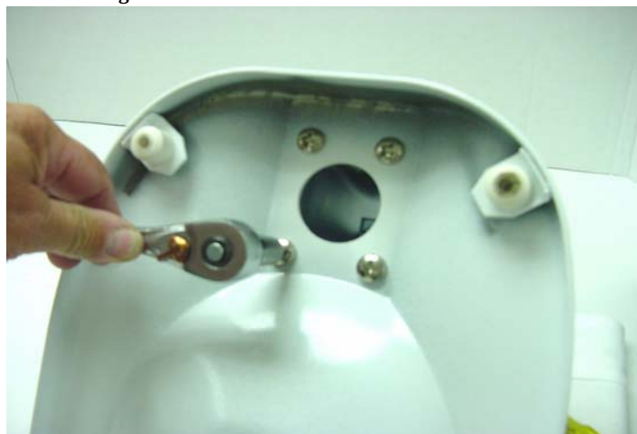
Abb. 86: Vier Schrauben am Sockel entfernen.
