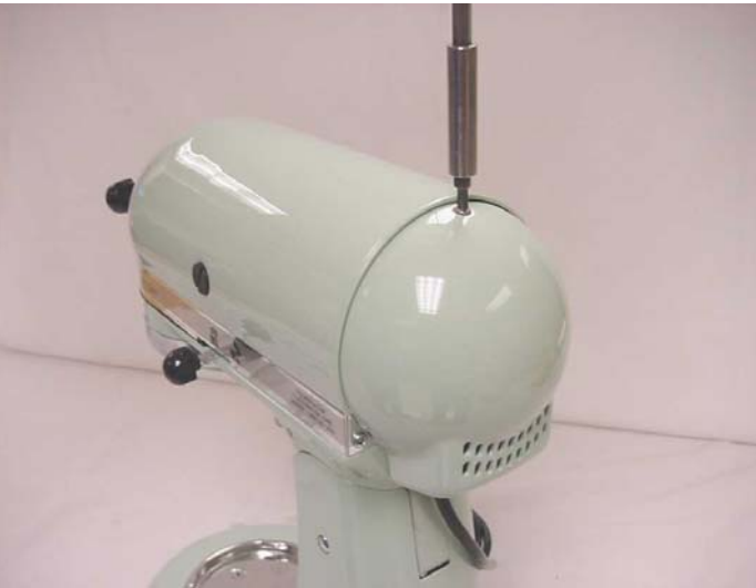
Abb. 1: Hintere Abdeckung nach Lösen der Schraube abnehmen.
