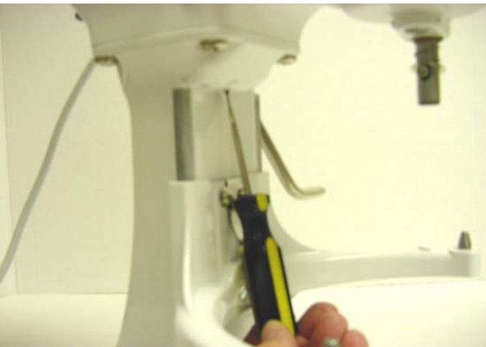
Abb. 97: Einstellung des Abstands zwischen Schüssel und Rührwerkzeug.
