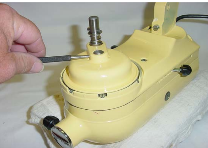
Abb. 67: Bohrungen von Welle und Planeteneinheit mit einem spitzen Durchschlag ausrichten.
