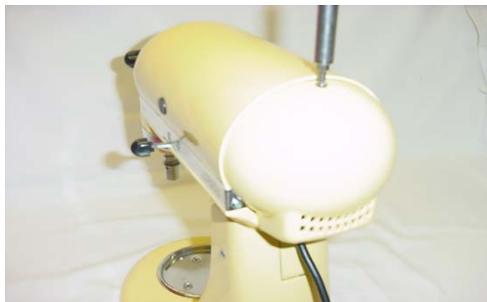
Abb. 82: Hintere Abdeckung mit der Schraube befestigen.
