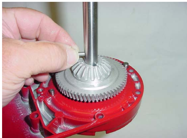
Abb. 53: Nach Hochschieben der Zentralwelle den Querstift entfernen.
