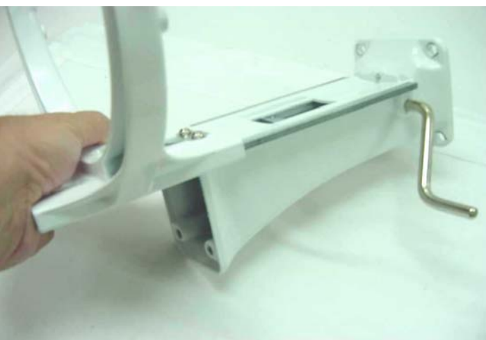
Abb. 88: Schlüsselträger nach unten von der Säule abziehen. G. Zum Einbau eines neuen Schlüsselheberarms den Spann-/Rollstift austreiben (Abb. 89). Danach Schlüsselhebergriff herausziehen (Abb. 90). Nun können Schlüsselheberarm und Mechanik entnommen werden.
