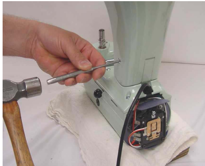
Abb. 4: Scharnierstift mit Durchschlag und Hammer austreiben.
