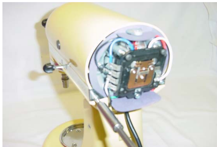
Abb. 81: Zierband nach der Drehzahleinstellung montieren.
